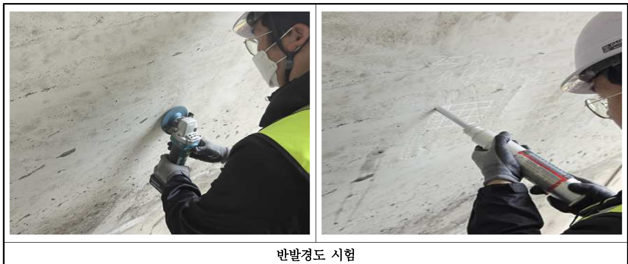
【사진 2.4.1】 강도시험 현장사진
